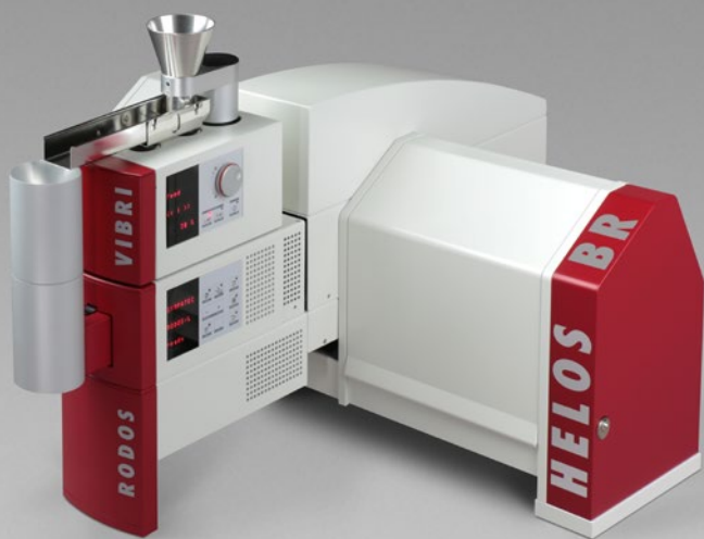
Trockendispergierer RODOS/L mit Dosierer VIBRI/L im Laserbeugungssensor HELOS/BR
