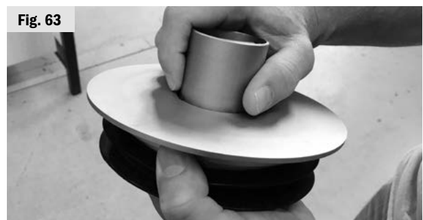
4. Per modificare il livello di riempimento, rimuovere il tappo di troppopieno dallo scarico e ruotare il tubo sporgente contro il disco di tenuta. Ruotate il tubo in senso anti-orario, per aumentare il livello di riempimento. Ruotare il tubo in senso orario per abbassare il livello. Provare una nuova impostazione e assicurarsi che la vasca non trabocchi.
