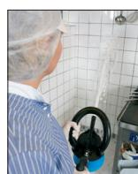
**9.** La distance entre l'embout des buses de l'injecteur et la surface à nettoyer doit d'être de 50cm minimum.
