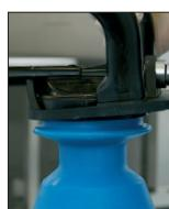
**5.** Skruva fast injektorn på behållaren
