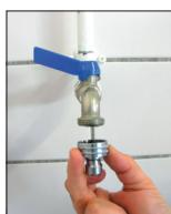
**1.** Montieren Sie den Hahnanschluß (0700) an den Wasserhahn.
