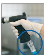
**7.** Vattenslang med ½" snabbkoppling placeras på pistolnippeln.
