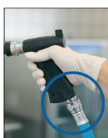
**7.** Le tuyau avec raccord rapide 1/2" (article n° 0702) est raccordé à l'embout du pistolet à eau.
