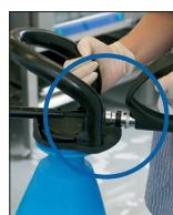
**6.** Le pistolet à eau (article n° 93209 ou 93219) est raccordé à l'embout de l'injecteur.
